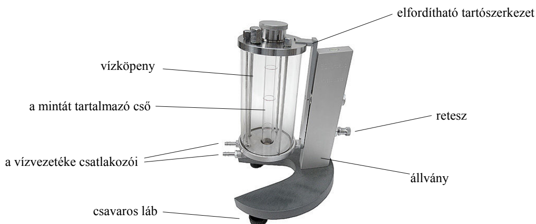
1.9. ábra. Höppler-viszkóziméter fényképe
