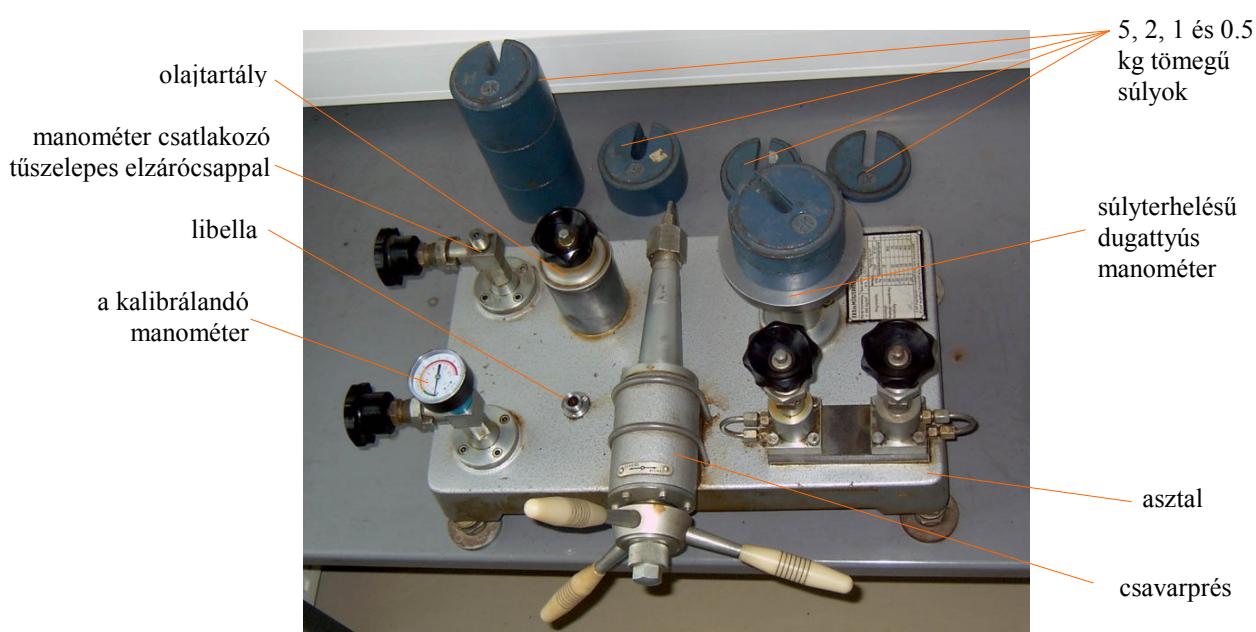
2.10. ábra. Dugattyús manométer-kalibráló készülék
