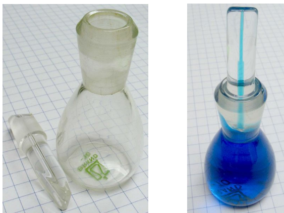
1.1. ábra. Egyszerű piknométer üres és feltöltött állapotában
