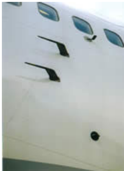
3.4. ábra. Prandtl- (Pitot-)szondák egy Boeing 747 repülőgép törzsén
