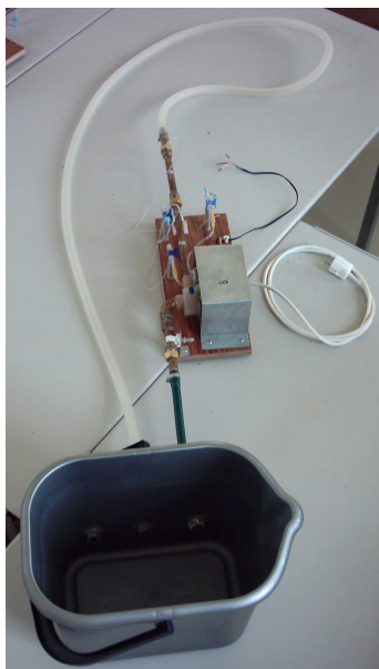
5.6. ábra. A szivattyúk jelleggörbéjének kísérleti megállapítására szolgáló berendezés
